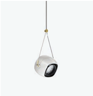
PENDELLEUCHTE FÜR FILORAIL Ø62 | Ø88 | Ø116 mm Bis zu 2520 lm Bis zu 115 lm/W F | WF DALI Broadcast | DALI Powerline | Casambi
